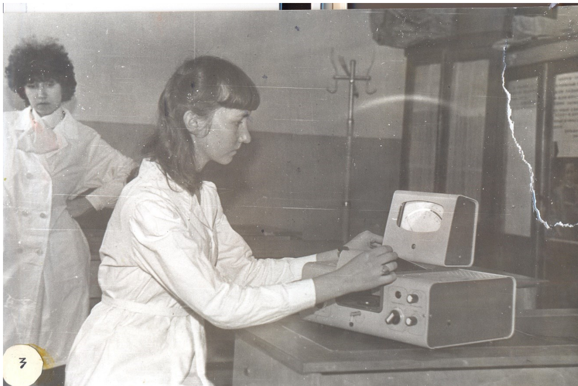
Студентка Вабищевич О. проводит эксперимент с использованием фотоэлектрочелюметра
